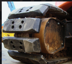
Chain on Type Befestigung mittels Schrauben direkt auf dem Kettenstrang
